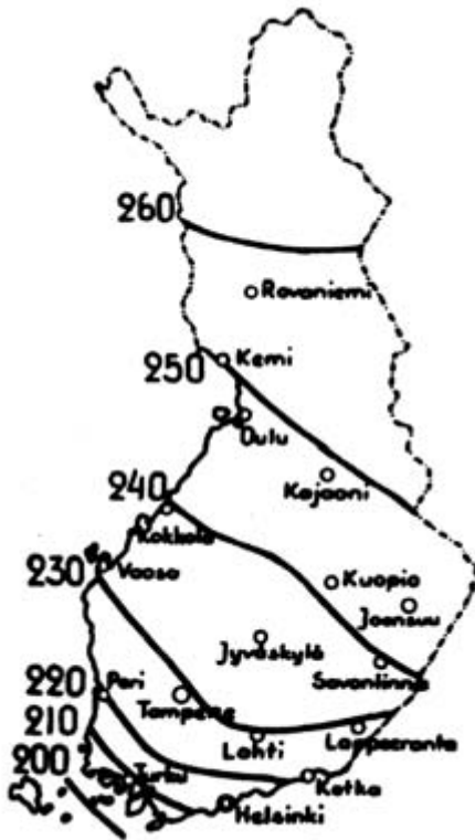
Kuva 15.1. Roudaton syvyys hietamaassa (cm) [D1 2007, kuva 6].
