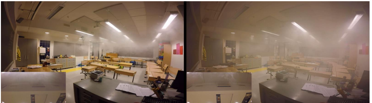
Kuva 10. Ilmanjaon suuntaukset savukokeiden avulla. Kuvissa on savun leviäminen samassa ajassa ennen suuntauksia ja suuntausten jälkeen. Vasemmassa kuvassa ennen suuntauksia tuloilma aiheutti oikosulkuvirtauksia ja tilaan jäi tuulettumattomia katvealueita. Oikeassa kuvassa suunnattavien tuloilmalaitteiden uudelleensuuntauksilla puutteet saatiin korjattua. Savukokeiden esittelyvideo [Antti Alanko]
