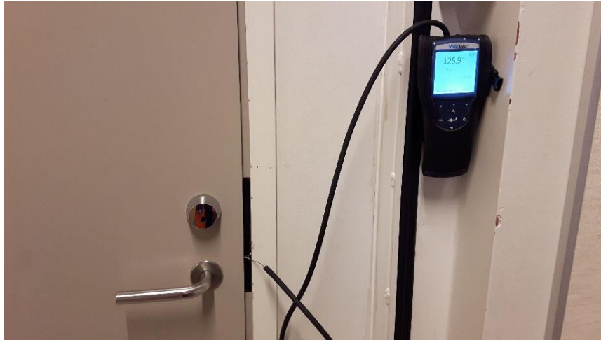
Kuva 59. Paine-eron mittaus kapillaarikoukulla välioven yli [Antti Alanko]
