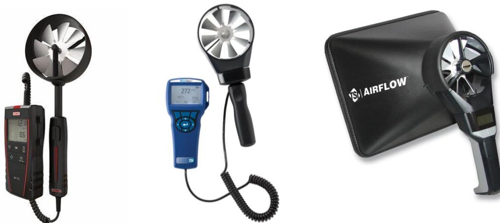
Kuva 32. Siipipyöriänemometrejä; Kimo LV110-s [Kimrok], TSI TC5725 & LCA301+Aircone [Tecnokolor]
