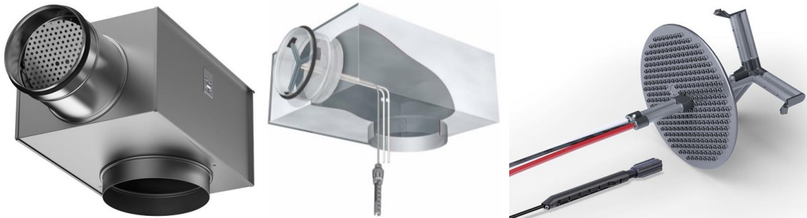
Kuva 23. Tasauslaatikko ja tasauslaatikon periaatekuva. Oikealla FläktGroupin mittaus- ja säätöosa ZAEF [Swegon ALS, FläktGroup ATTC & ZAEF]
