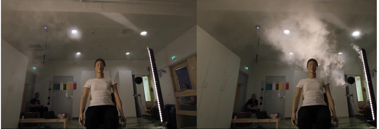
Kuva 4. Ilmanjaon toiminta eri tehotasoilla. Vasemmalla 100 %, oikealla 50 %. Osateho aiheutti enemmän vetoa oleskeluvyöhykkeellä. [Kemppe, J. 2018]
