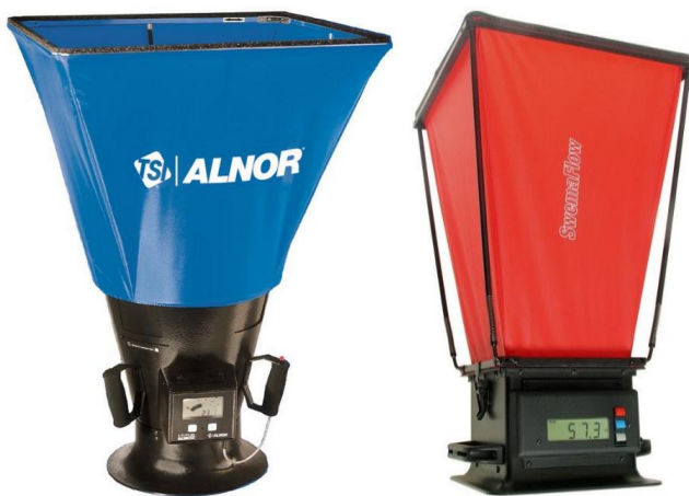
Kuva 31. Huppumittareita; TSI Alnor [Teknocolor], SwemaFlow [Pietiko]
