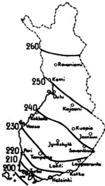
Kuva 15.1. Roudaton syvyys hietamaassa (cm) [D1 2007, kuva 6].
