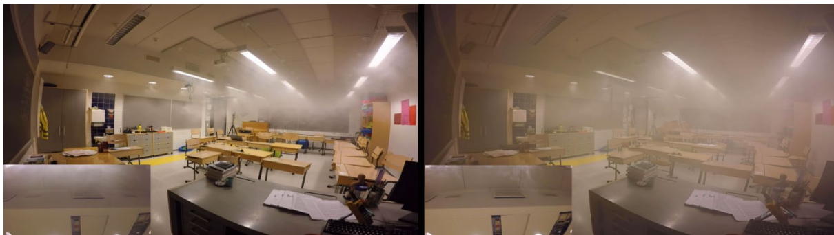
Kuva 10. Ilmanjaon suuntaukset savukokeiden avulla. Kuvissa on savun leviäminen samassa ajassa ennen suuntauksia ja suuntausten jälkeen. Vasemmassa kuvassa ennen suuntauksia tuloilma aiheutti oikosulkuvirtauksia ja tilaan jäi tuuletettomia katvealueita. Oikeassa kuvassa suunnattavien tuloilmalaitteiden uudelleensuuntauksilla puutteet saatiin korjattua. Savukokeiden esittelyvideo [Antti Alanko]
