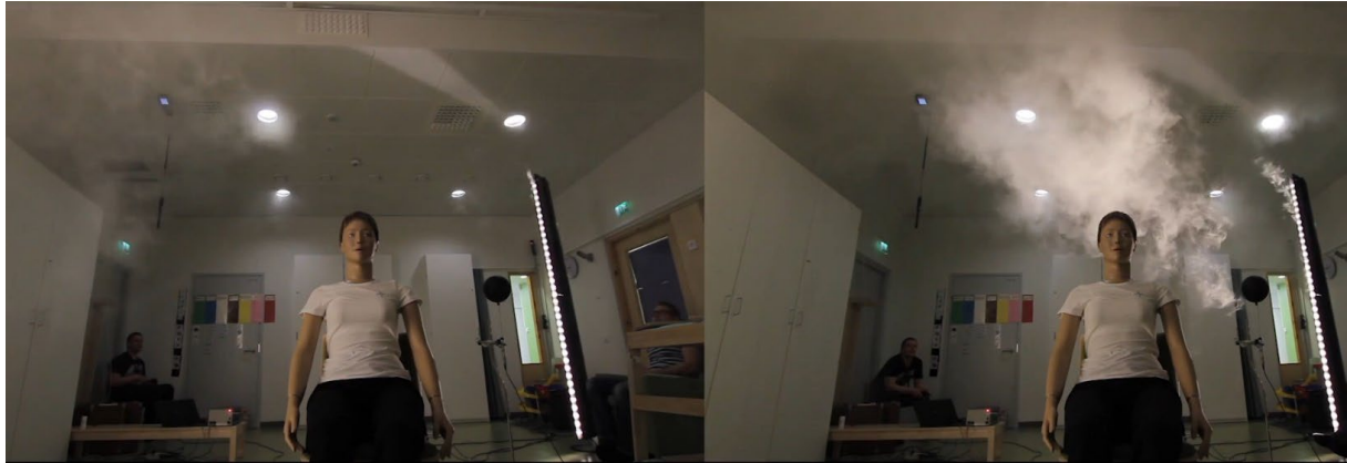
Kuva 4. Ilmanjaon toiminta eri tehotasoilla. Vasemmalla 100 %, oikealla 50 %. Osateho aiheutti enemmän vetoa oleskeluvyöhykkeellä. [Kemppe, J. 2018]
