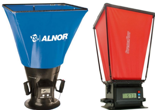
Kuva 31. Huppumittareita; TSI Alnor [Teknocalor], SwemaFlow [Pietiko]
