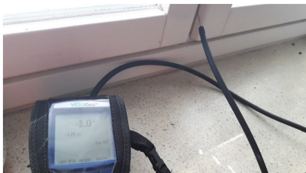
Kuva 56. Paine-eron mittaus kapillaarikoukulla tuuletusikkunan yli [Antti Alanko]
