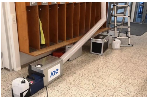
Kuva 9. Ilmanjaon savukoelaitteisto kanavistoon kytkettynä. [Antti Alanko]
